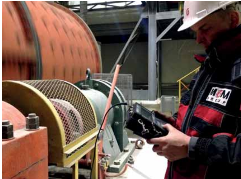
Рис. 19. Виброобследование подшипников ОАО «ЮГК» Светленская ЗИФ
