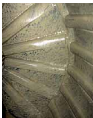
Рис. 9. Резиновая футеровка МШЦ 36x40 ЗИФ Многовершинное
