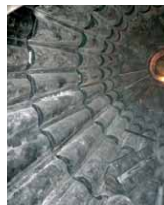
Рис. 10. Резиновая футеровка 1-й камеры СМ 3,5x15 Красноярскцемент
