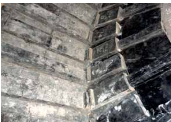
Рис. 8. Резиновая футеровка ММС 70x23 HeidelbergCement
